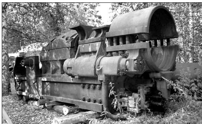
Станок 12-дм орудия в коллекции частного музея Хейкки Похьолайнен в Хювинкя (Финляндия). Хорошо видна конструкция станка (Предоставлено Колин Партридж (Великобритания))
